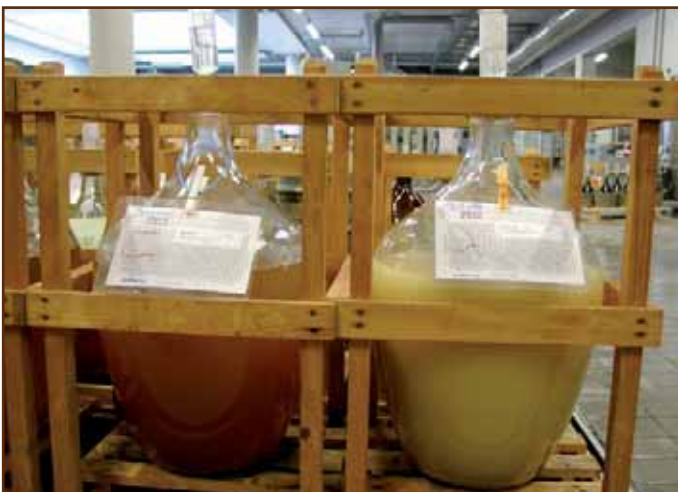
Abb. 3: Gegenüberstellung eines anderen Gärversuches (links, noch keine Gäraktivität nach fünf Tagen) und mit Reinzuchthefen beimpfte Gärung (rechts, zu 75% vergoren).
