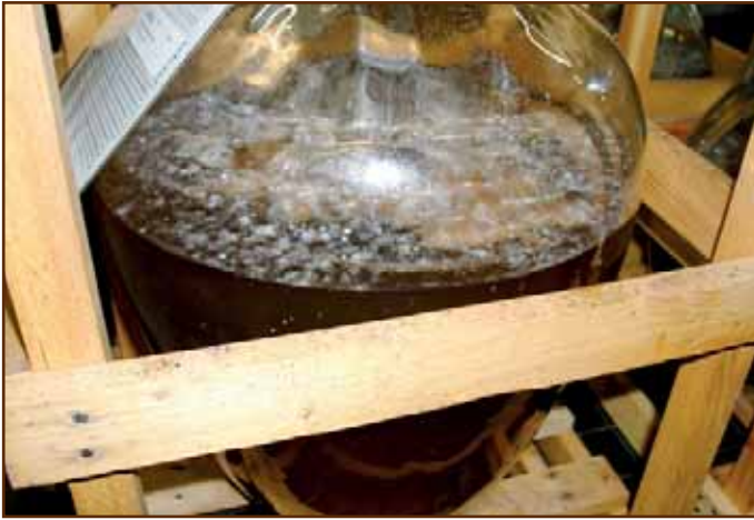
Abb. 1: Glasballon mit Most zur Durchführung einer Spontangärung mit Schimmelpilzrasen nach vier Tagen.
